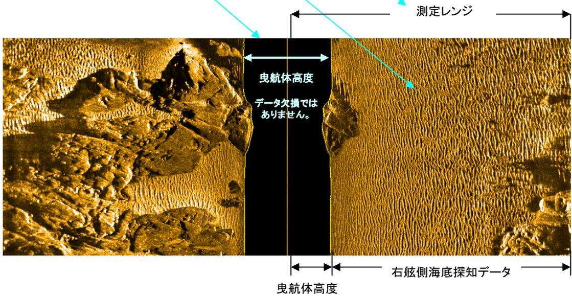
斜距離補正後、曳航体高度を省き、左右舷の海底を合わせたデータ。
