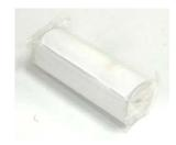
③ LLT 用80 φ ゴムチューブ(内、外) 15491-1031、1032 1セットOYO 製孔内水平載荷試験装置 LLT、LLT-M でご利用いただけます。
